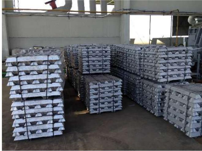
**Figure 4.** Aluminium ingots
